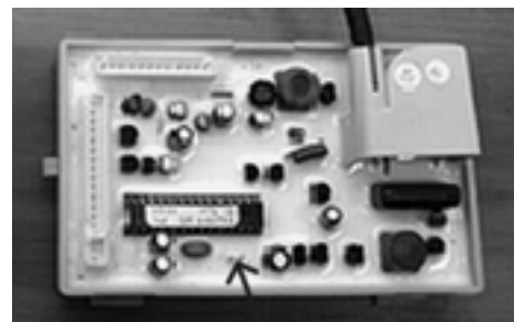
Рисунок 9. Место установки переключки в регуляторе розжига
