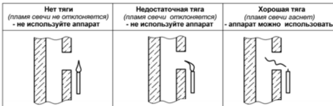
Рисунок 4. Способ проверки тяги в дымоходе
