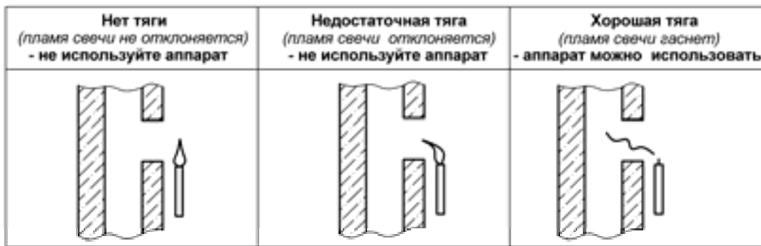
Рисунок 4. Способ проверки тяги в дымоходе
