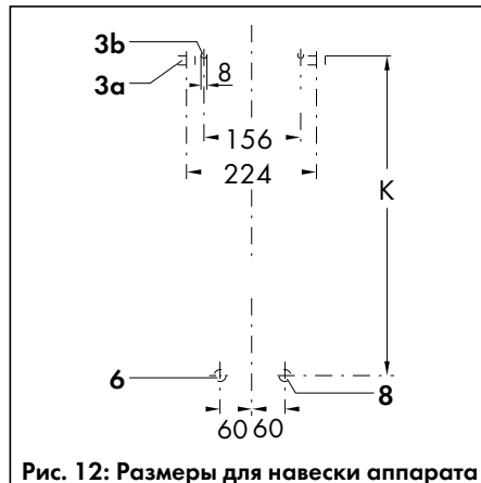
Рис. 12: Размеры для навески аппарата
